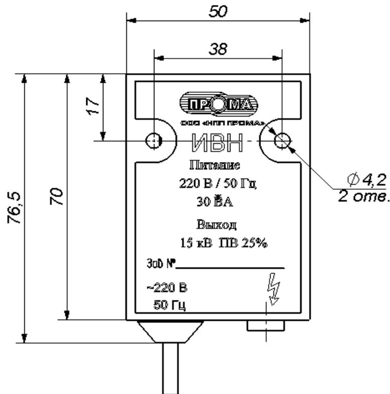
Настоящее руководство по эксплуатации распространяется на источник высокого напряжения ИВН, являющегося самостоятельным прибором или составной частью запально-защитных (ЗЗУ), запально-сигнализирующих (ЗСУ), электрозапальников (ЭЗ, ЭЗГ) или других устройств различных модификаций.
